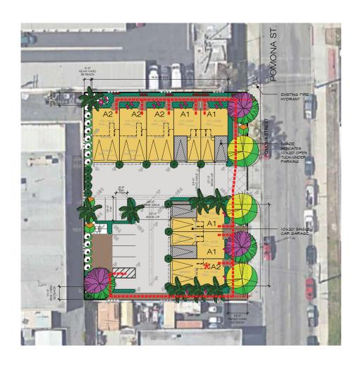
LEGEND RESIDENTIAL UNITS PROPOSED TRANSFORMER COLORED STAMPED CONCRETE DRIVE ADAPTABLE UNITS AT GRADE LEVEL
